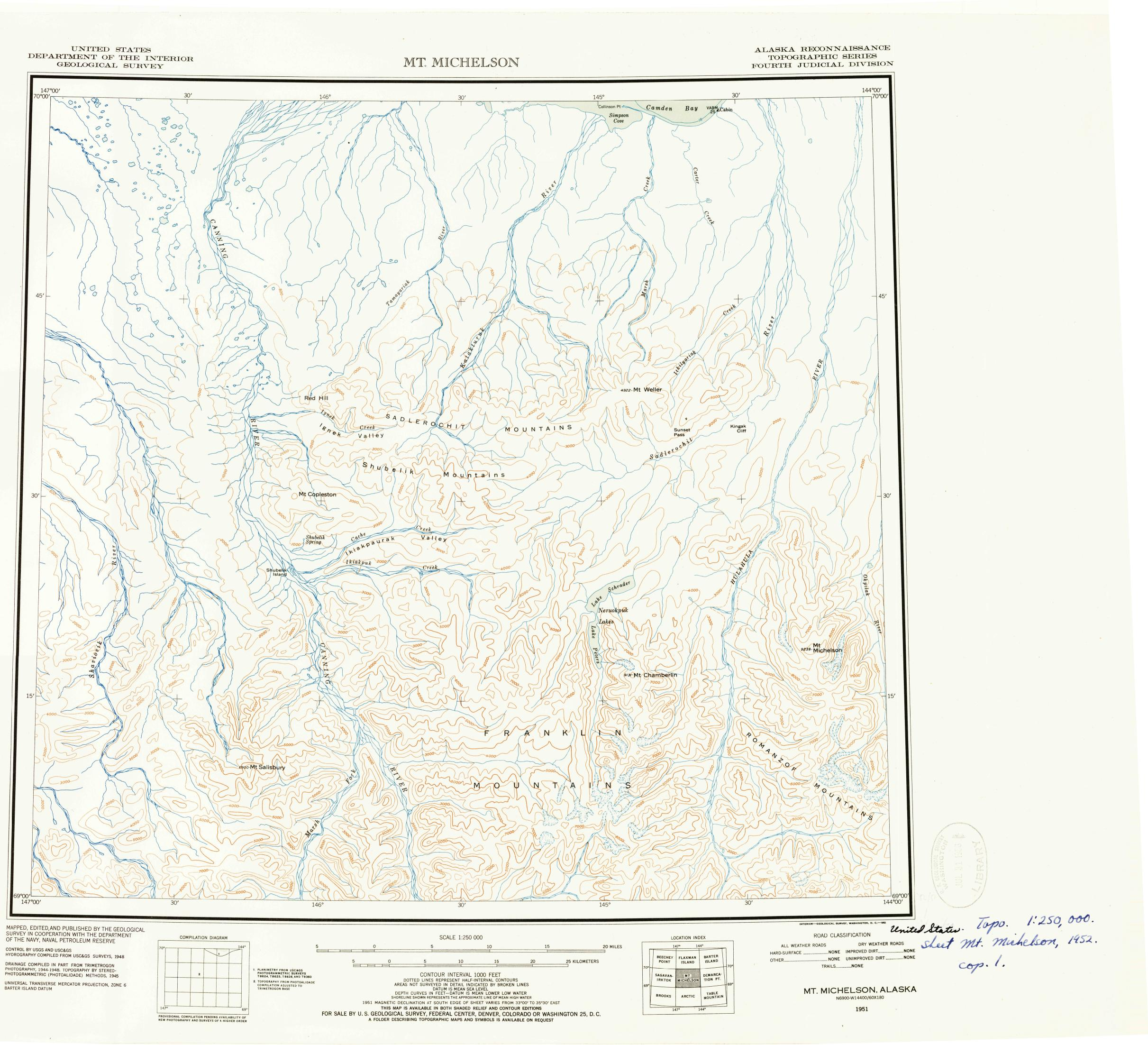
DRAINAGE COMPILED IN PART FROM TRIMETROGON PHOTOGRAPHY, 1944-1948. TOPOGRAPHY BY STEREO-PHOTOGRAMMETRIC (PHOTOALIDADE) METHODS, 1945
